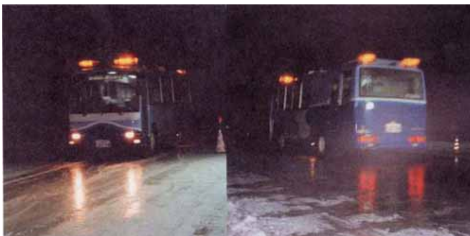
写真 - 5 北海道開発土木研究所のすべり試験車による測定状況
