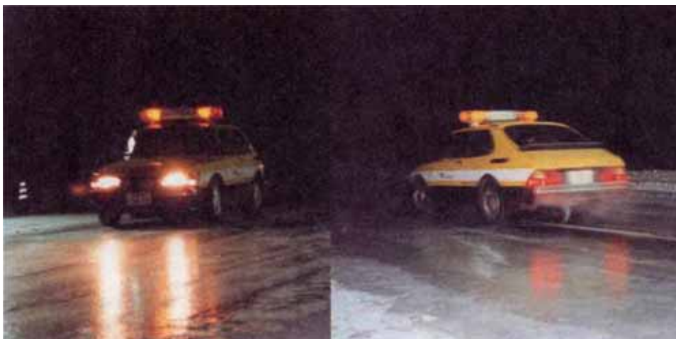
写真 - 4 サープ(連続すべり試験車)による測定状況
