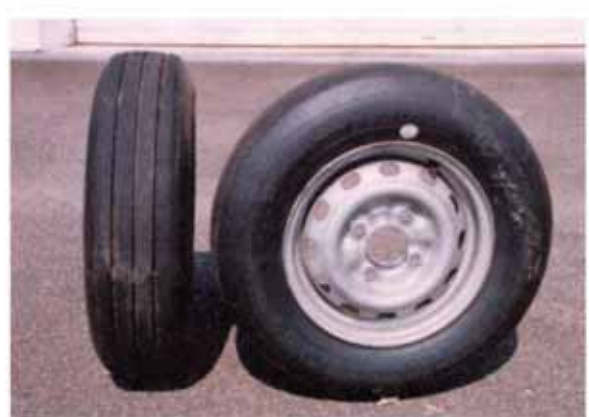
写真 - 3 夏用路面すべり測定用標準タイヤ(リブタイヤ)
