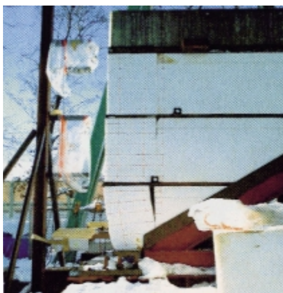
写真 - 1 レベル2加振後の状態 (ケース1: アンカー・壁体なし)
