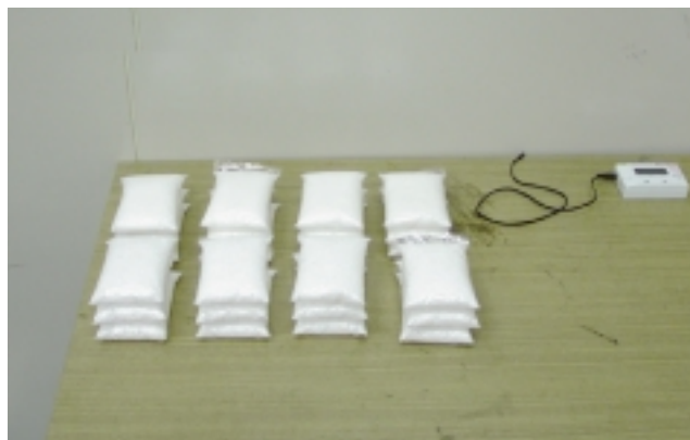
写真-4 供試体設置状況(載荷重なし)
