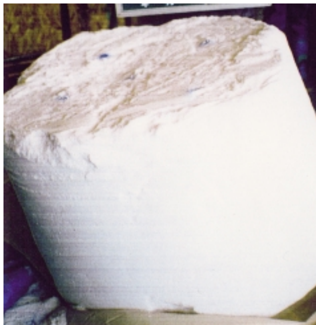
写真-1 塩化ナトリウムの固結状況
