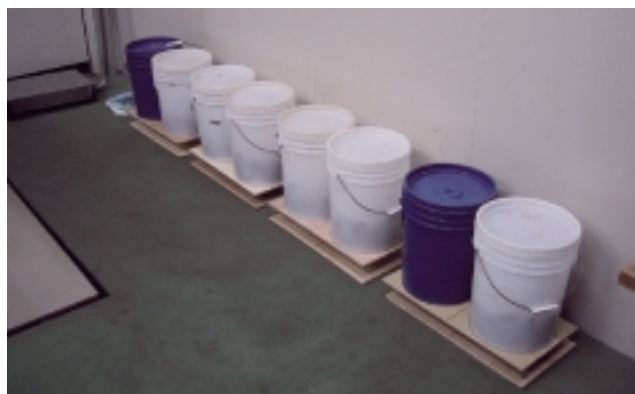
写真-5 供試体設置状況(載荷重あり)
