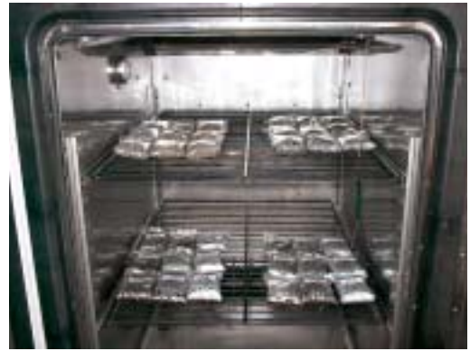
写真-5 防滑材保管室内試験の状況
