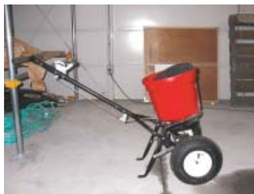
写真 - 4 簡易散布装置
