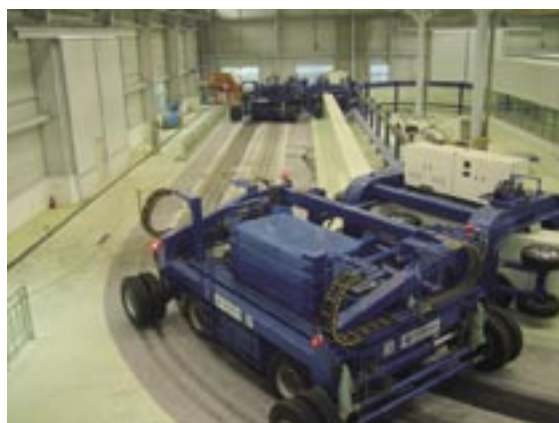
写真－３ 促進荷重試験装置
