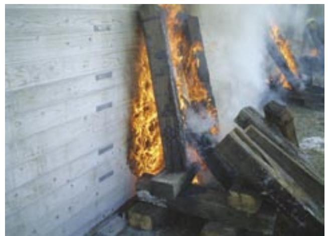
写真－3 レベル2燃焼試験実施状況
