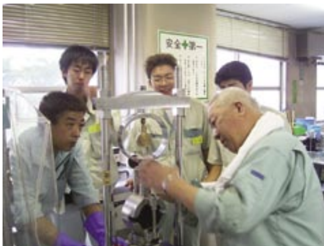
写真-6 マーシャル試験
