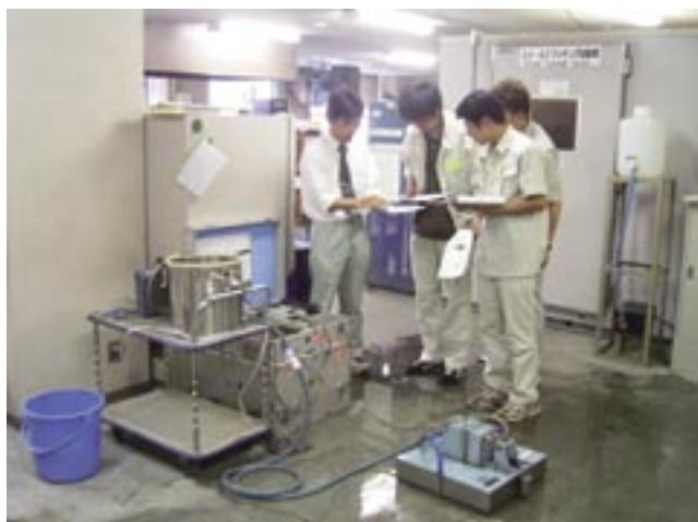
写真-2 DFテストによる動摩擦係数の測定
