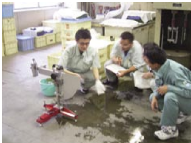
写真-3 ポータブルスキッドテストによるすべり抵抗値の測定
