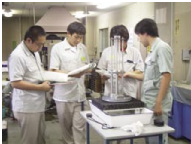
写真-4 現場透水量試験器による現場透水量の測定
