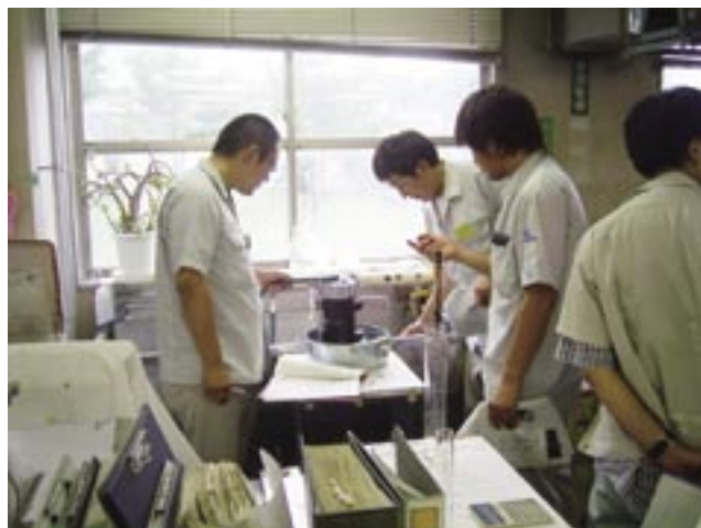
写真-5 透水試験器による透水係数の測定
