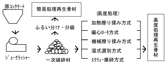
図-2 再生骨材の製造方法
