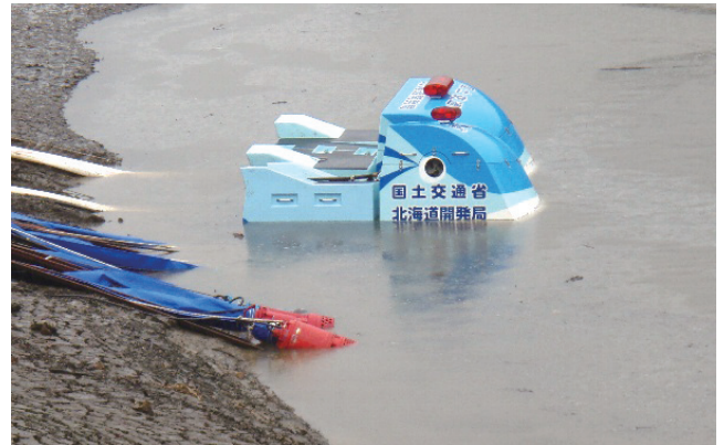
図-2 奥沢ダム貯水池における北海道開発局支援による自走式ポンプの稼働状況
