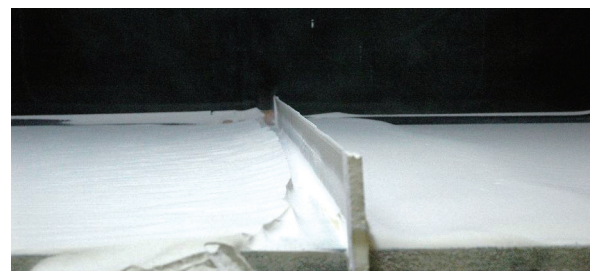
写真-1 活性白土を使用した実験での吹きだまり
