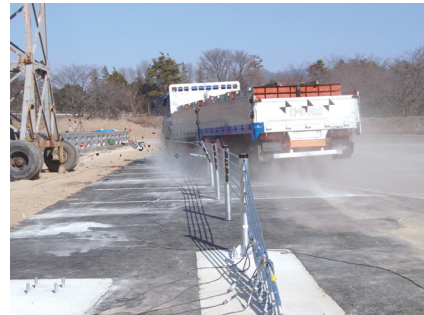
緩衝型ワイヤーロープ式防護柵の衝突試験
