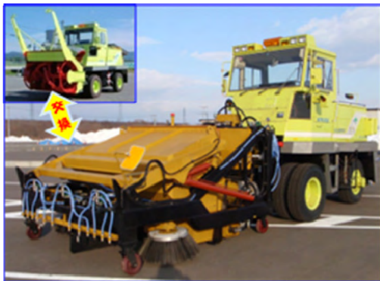
写真-1 ロータリ除雪車対応型路面清掃装置(ロータリ除雪車両+試作機)
