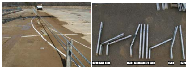
写真-10 衝突後の状況と損傷した支柱
