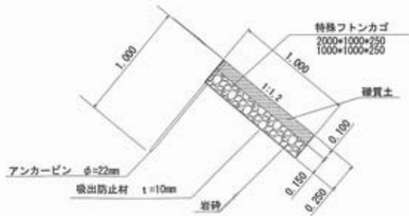
図-8 特殊フトンカゴ設置部への中低木導入断面図
