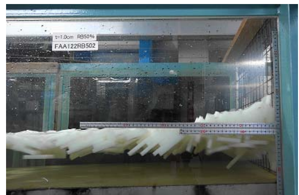
写真-3 模型実験によるパイルアップ状況
