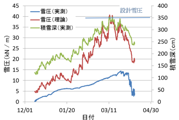
図5 中山峠における雪圧計測結果(2012-13)
