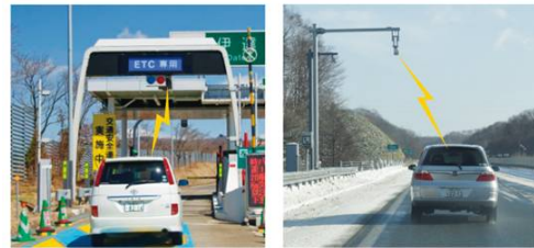
図-4 同じ周波数帯を用いるETCとITSスポット
