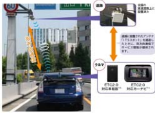
図-1 ITSスポットと車載器の双方向通信
