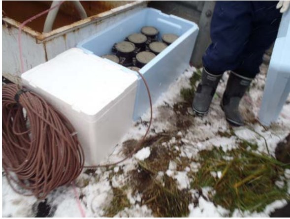
写真-4 断熱材（厚さ 20mm）による保温箱養生
