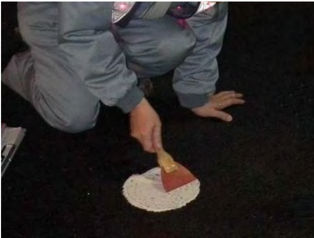
写真4 サンドパッチング法によるきめ深さの測定
