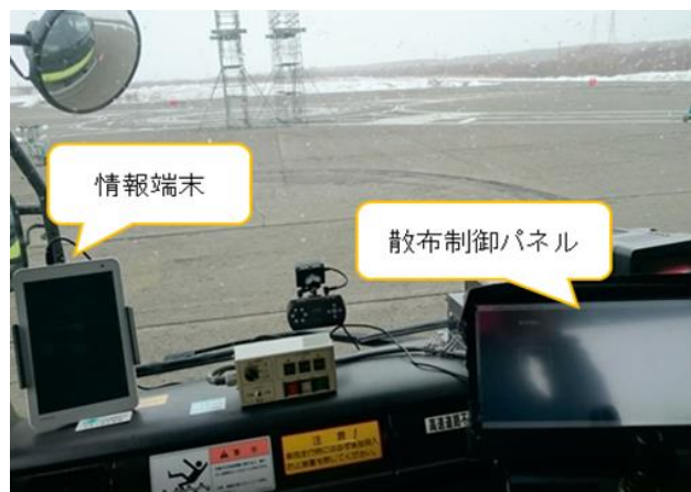
写真-2 車内助手席前に設置した各機器
