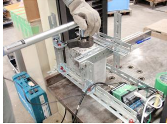
写真-8 室内実験（トルク・引抜き強さ確認試験）
