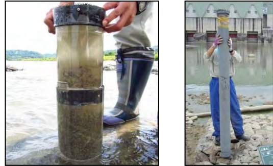
写真-4 左：砂貯め部の満砂状況 右：拡張した砂貯め部
