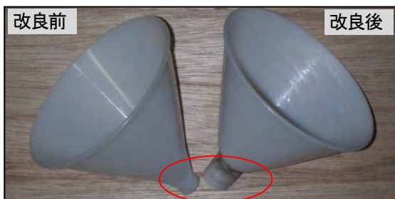
写真-3 ロート部における改良前(左)と改良後(右)の比較
