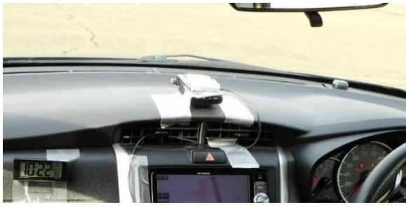
図-12 ドライブレコーダ設置状況
