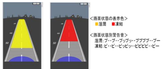
図-2 情報端末による路面状態の情報提供例
