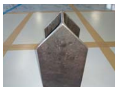
写真-9 採用された支柱形状
