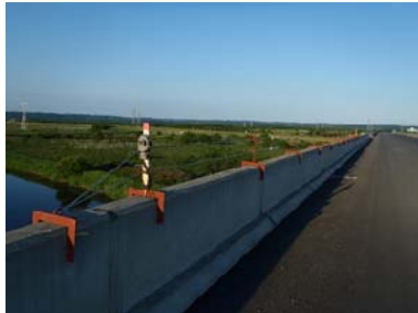
写真-7 仮設ワイヤーとインターバルカメラの設置状況
