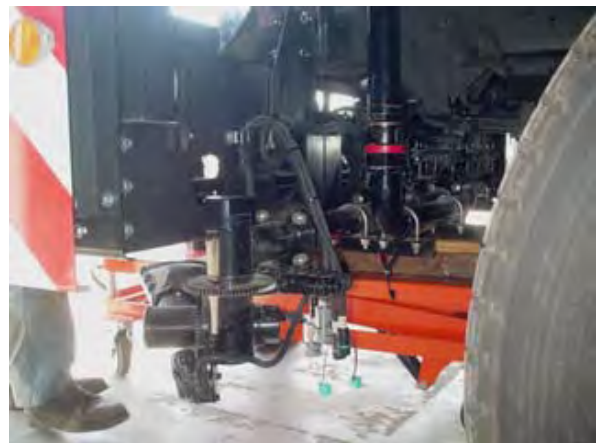
写真-8 散水ノズル（フロントバンパ）の脱着
