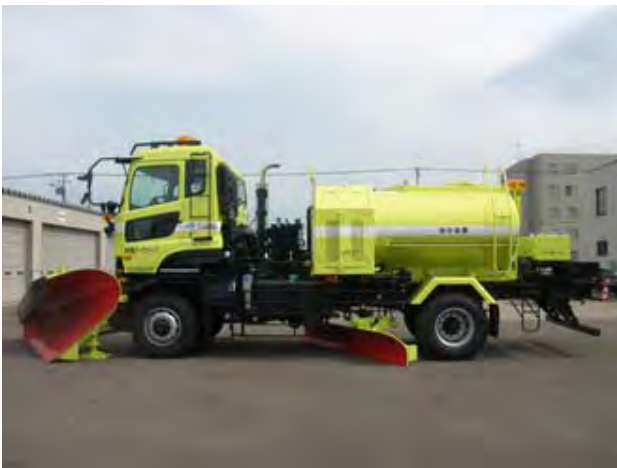
写真-1 除雪トラック(散水装置付き)
