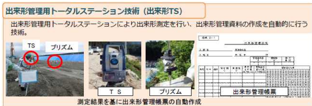
図-3 出来形管理用TS技術
