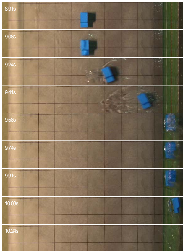
写真-3 車両模型の漂流状況 ( T=5s, H=4cm, h_w=2cm, typeA )
