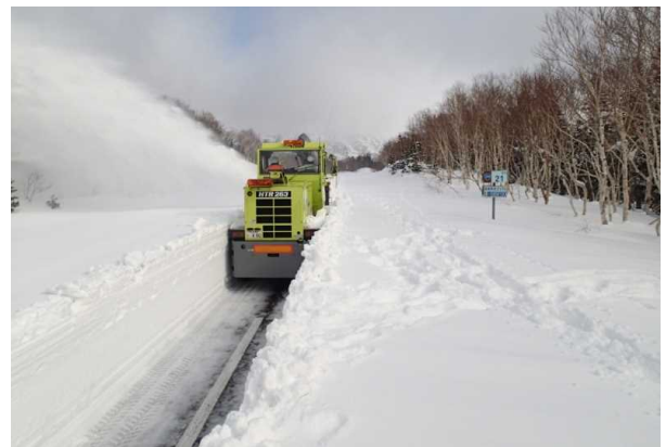
写真-2 ロータリ除雪車による雪割り除雪
