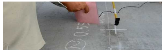
a) 健全供試体 測点②の周波数分析結果と状況
