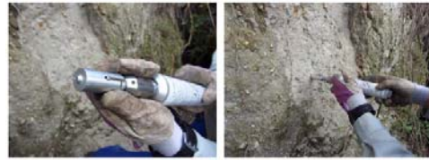
写真5 針貫入試験の状況
