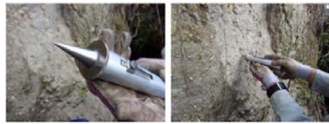
写真6 土壌硬度試験の状況
