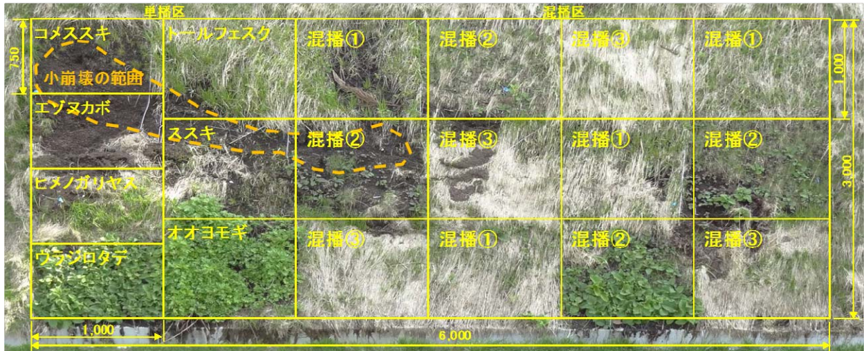
図-5 試験区画の割付け（写真は北向き面）数字の単位はmm
