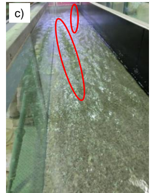
図-1 Case 1、2の水理条件で発生した三角波 9) 。a) Case 1実験開始5分後、b) Case 2実験開始5分後、c) Case 2実験開始30分後。
