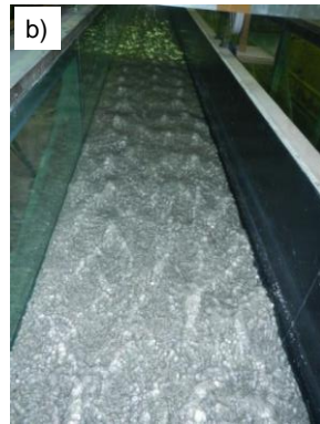
図-1 Case 1、2の水理条件で発生した三角波 9) 。a) Case 1実験開始5分後、b) Case 2実験開始5分後、c) Case 2実験開始30分後。
