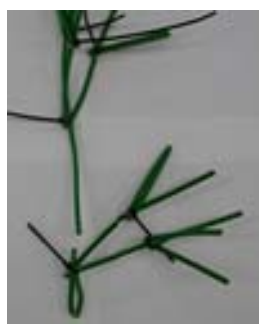
写真-5 破断状況
