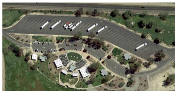
写真-4 Philip S. Raine Roadside (写真:Google maps) (一般車とトラックの駐車場が分離されている例)
