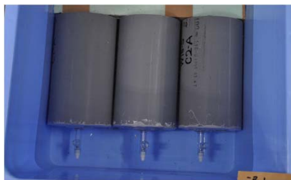
写真-3 ひび割れ供試体への水浸漬状況
