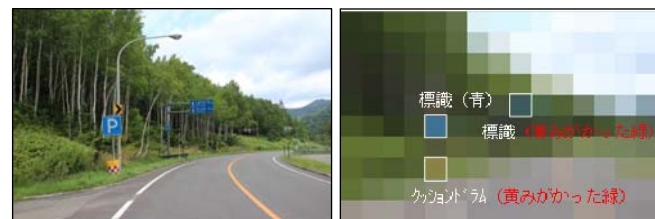
図-1 モザイク分割のイメージ (左: 元画像、右: 15×10 分割モザイク画像)
