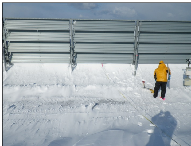
写真-2 吹き払い柵風下の吹きだまり深さ計測
