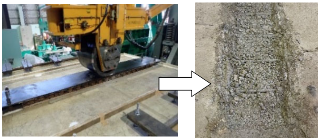
写真-1 R C床版の土砂化(輪荷重走行試験)
