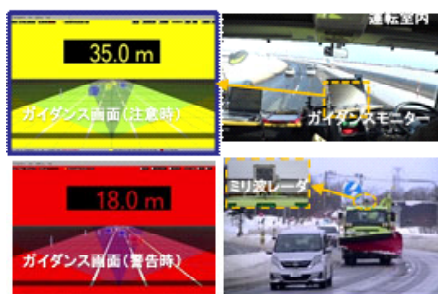
図-1 前方障害物探知ガイダンスによる現道走行実験状況
