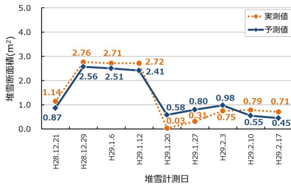
図-2 分類A累計②（車道部堆雪断面積）による比較例（H28、札幌 R5地点②）
