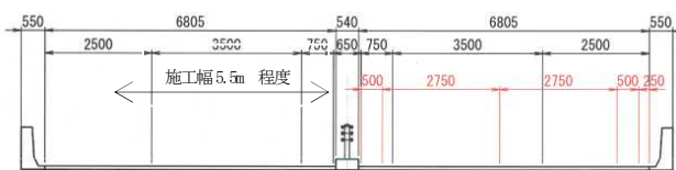
図-8 片車線対面交通規制図
