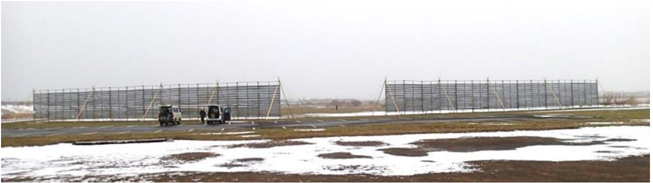
図-3 風下側から見た吹きだめ柵の様子 (左：斜交柵、右：直交柵)
