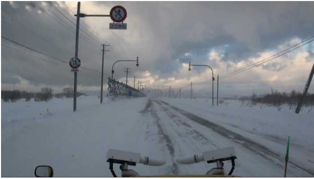
図-5 視程計測値と吹雪状況が相違している画像 (視程計:86m(視程ランクE)、画像を目視して読み取った 視程:視程ランクB)
