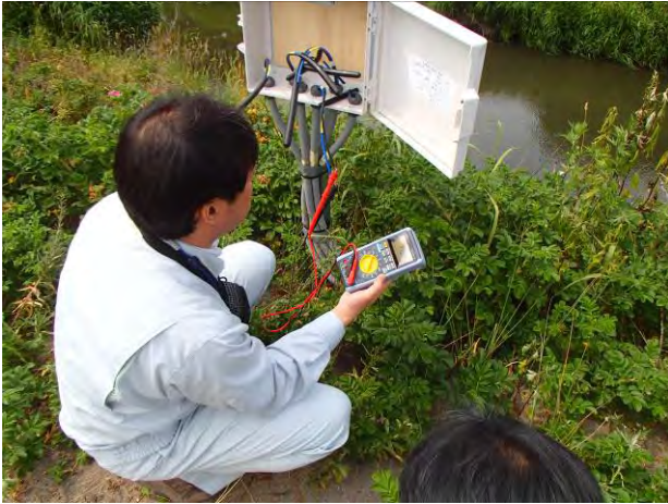
写真- 2 自然電位測定状況
