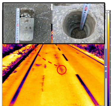
写真-2 赤外線画像による調査例
