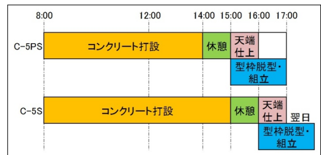
図-4 打設サイクル比較結果（打設量56m 3 /日の場合）
