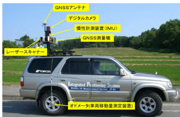
写真-2 移動計測システムを搭載した車両
