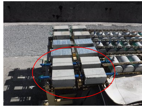
写真-1 コンクリート供試体暴露状況 (赤丸箇所)
