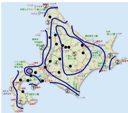
図-2 暴露実験箇所（図中の○の数値は凍害危険度）
